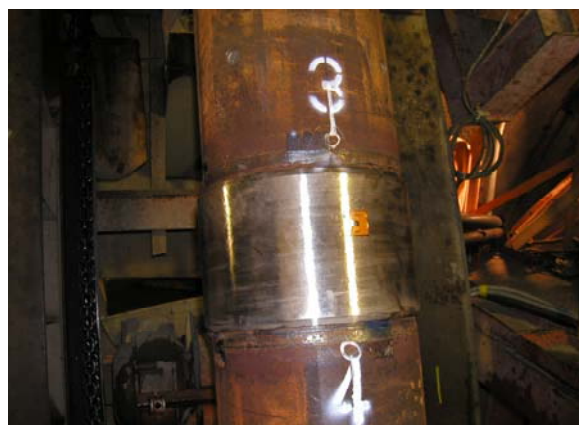
写真1. SMA継手による曲線鋼管の接続 5)
